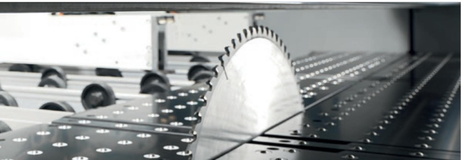
Les systèmes de pression sont équipés d'un dispositif efficace d'aspiration qui garantit une grande qualité de coupe tout en assurant une propreté permanente pendant le façonnage.
