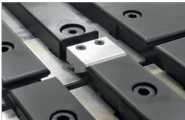
Système de fermeture de la ligne de coupe pour éviter la chute des déchets longitudinaux.
