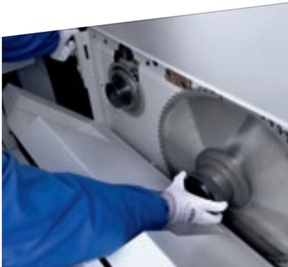
Le système « Quick change » est le dispositif le plus **rapide, ergonomique et sûr** pour le remplacement des lames sans l'utilisation d'outils.
